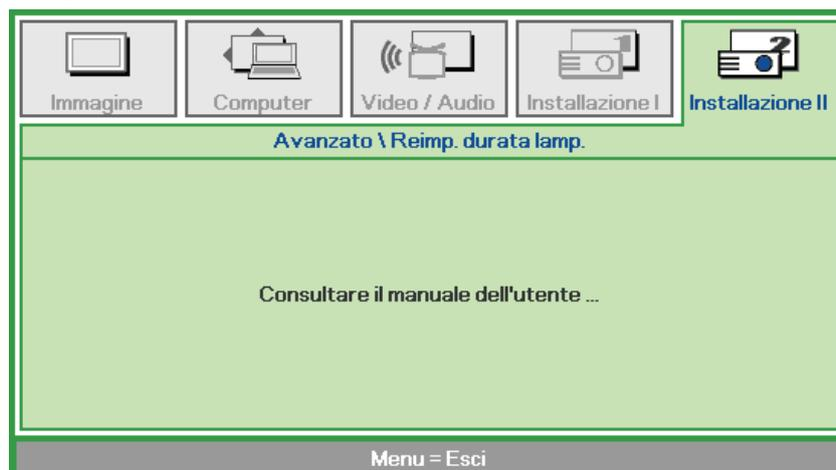
Vedere *Azzeramento del tempo* lampada a pagina 59 per azzerare il contatore delle ore di funzionamento della lampada.
